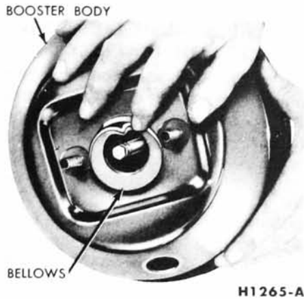
FIG. 21—Bellows-to-Booster Body Engagement
