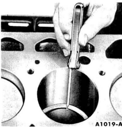
FIG. 21—Piston Ring Gap
