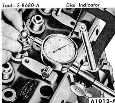
FIG. 34—Valve Stem Clearance
